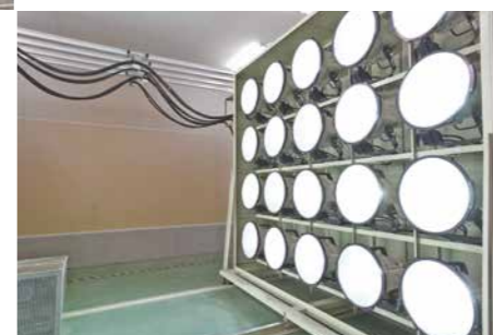
Prova di durata Replica le più rigide condizioni ambientali osservate in natura combinando luce intensa e temperature elevate.
