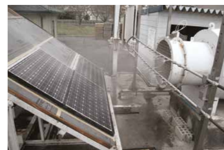
Prova di resistenza al carico del vento Simula le condizioni alle quali vengono esposti i moduli durante un violento uragano.
